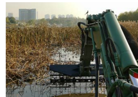
Limpieza de vegetación y escombros usando rastrillos
